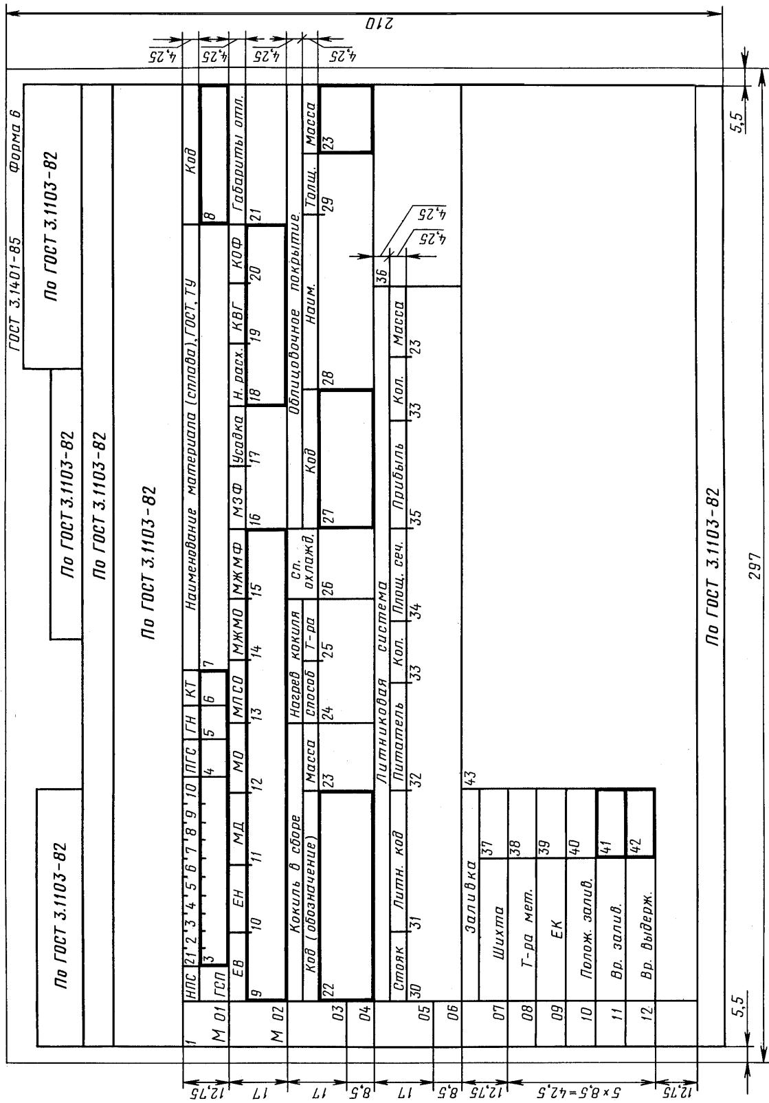
Карта технологической информации к ЕТИ (ТПП, ГПП) литья по выплавляемым моделям для различных типов производств
